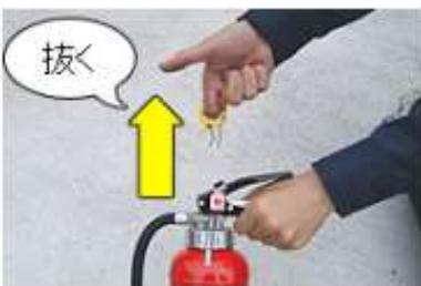
消火器の安全栓(安全ピン)を上方に向かって強く引き抜きます(ストッパーが倒れレバーが握れるようになります)。
